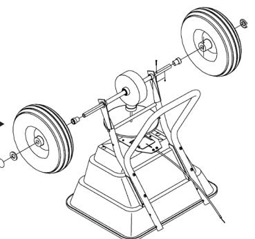
Monter højre hjul(L) og fastspænd hjulet med bolt (C) og møtrik (F). Fastgør hjulet fra ydersiden med hjulkapsel (J).
