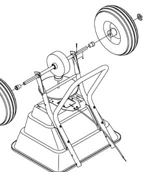
Montieren Sie das linke Rad und Scheibe (G) auf der Außenseite des Rades, das Rad mit der Radkappe (J) verschließen.
