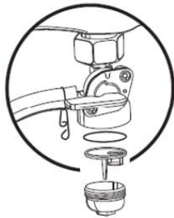
Montage de la cuve de sédimentation
