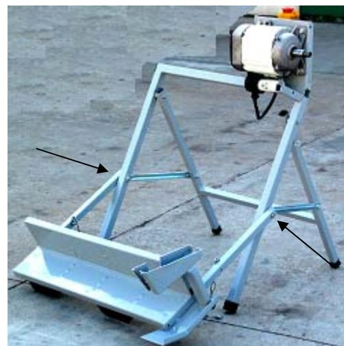
2. Nosta pidin "D" pystyasentoon kuvassa olevalla tavalla. Laita samalla suojuus "B" moottoriin.
