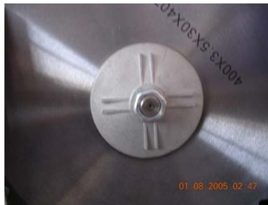
Oikealla oleva kuva esittää sahanterän valmiin asennuksen.
