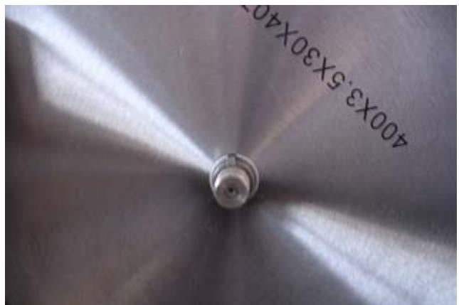
6. Kiinnitä sahanterän ulompi laippa moottorin akseliin ja kiinnitä mutteri. Kiristä mutteri jakoavaimella.
