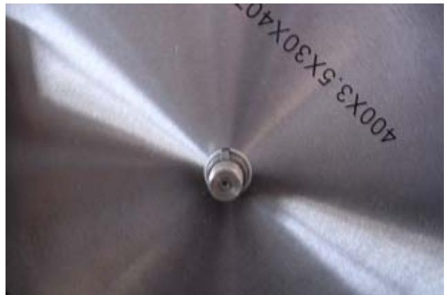
6. Monter den ydre flange som vist. Stram sikkert til med en skruenøgle.
