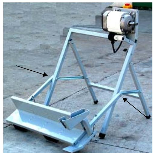
Soulever le support "D", comme indiqué, en plaçant en même temps le dispositif de protection sur le moteur.
