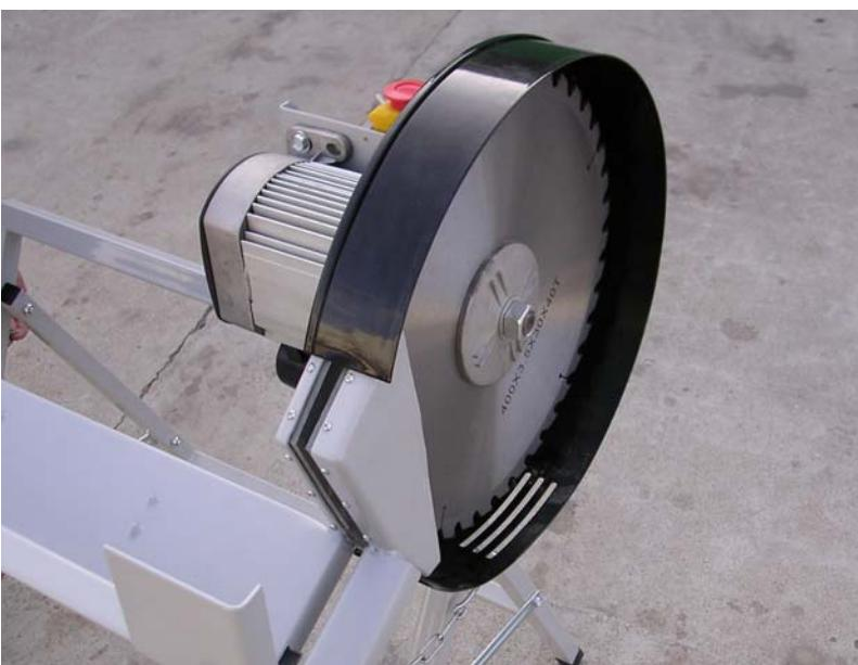
Fixer le dispositif de protection avec 3 longs boulons.
