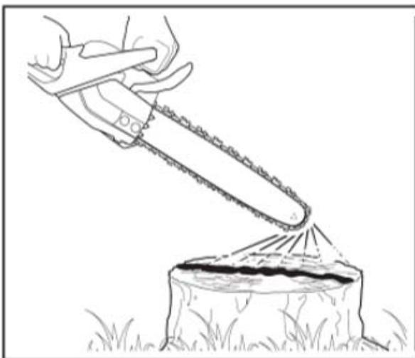
Se non esce olio, controllare che ci sia olio nel serbatoio dell'olio e assicurarsi che la scanalatura e i fori della barra di guida siano privi di sporco. Pulisci anche intorno all'uscita dell'olio dietro la barra della macchina.
