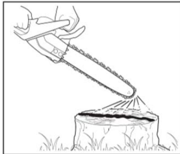
Tritt kein Öl aus, prüfen Sie, ob sich Öl im Öltank befindet, und vergewissern Sie sich, dass die Schraube und die Bohrungen frei von Schmutz sind. Reinigen Sie auch den Bereich rund um den Ölauslass hinter dem Schwertholz am Gerät.
