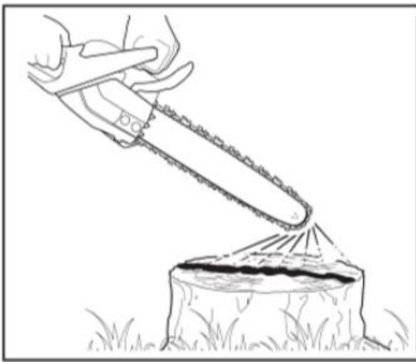
Hvis der ikke kommer olie ud, tjek at der er olie i tanken og vær sikker på at rillen og hullerne i sværdet er fri for urenheder. Rengør også rundt om hullet bag sværdet, hvor olien kommer ud.
